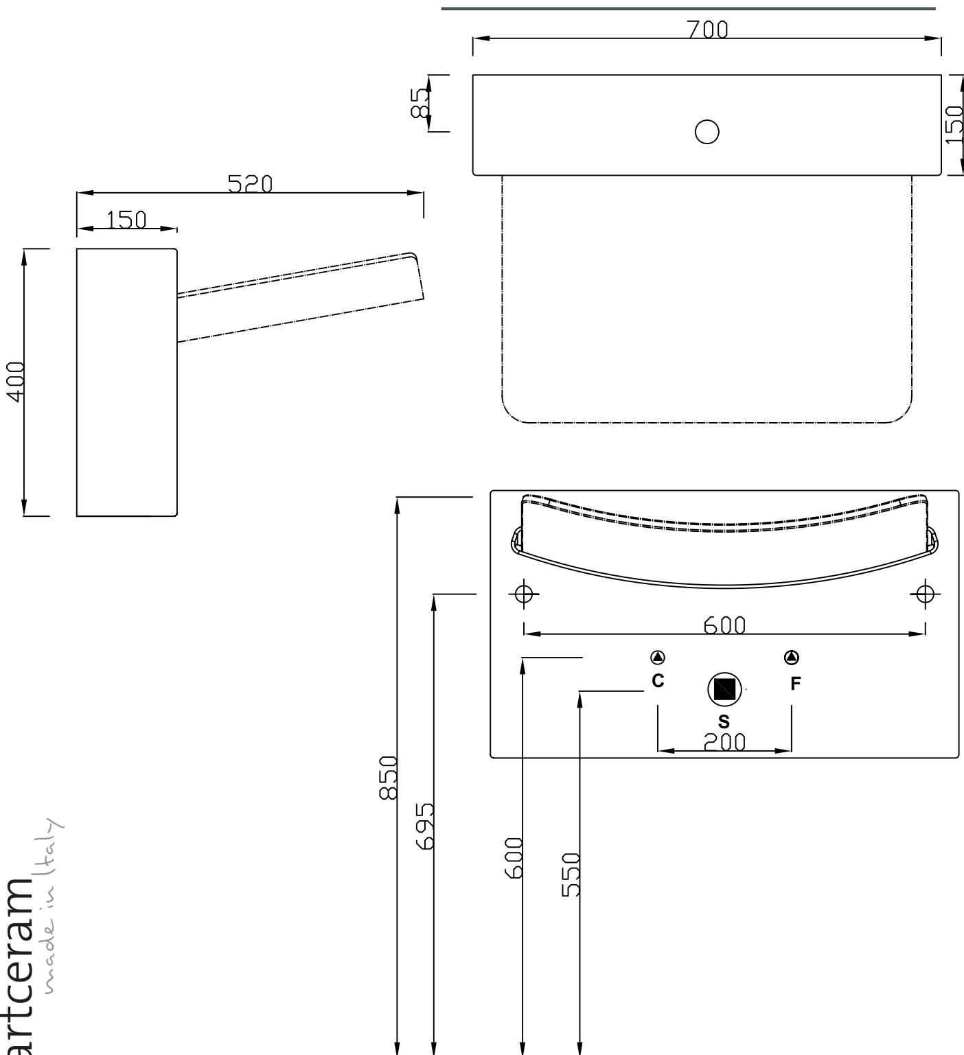
N.B. Le misure indicate possono subire una variazione dell 0,6% circa, dovuta ad usura stampi e a variazioni delle caratteristiche tecniche relative alle materie prime che compongono l'impasto .
