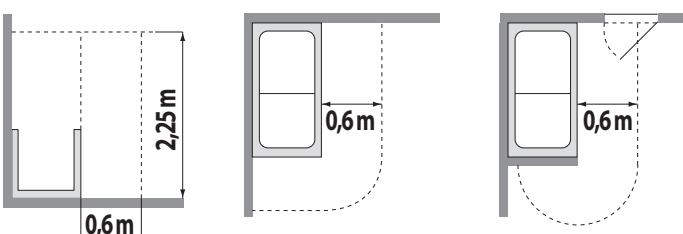
L'installazione di dispositivi elettrici ed apparecchi (prese, interruttori, ecc.) nelle sale da bagno deve essere conforme alle disposizioni di legge e norme di ogni Stato; in particolare non è ammessa alcuna installazione elettrica nella zona circostante l'apparecchiatura per una distanza di 60 cm ed una altezza di 225 cm.
