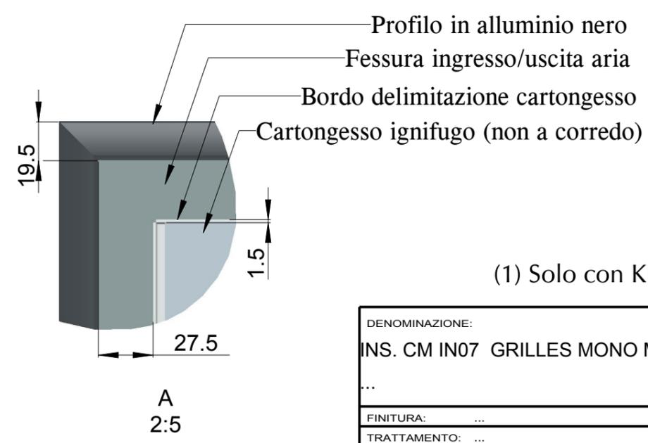
(1) Solo con KIT cod.: 70006071 00 per evitare la sostituzione delle pile
